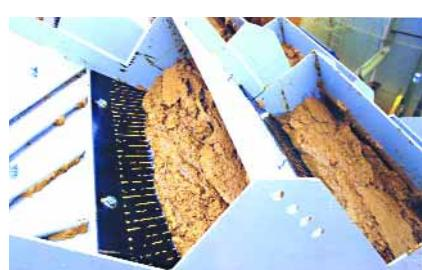
El sistema Finlay Siltmaster elimina la necesidad de balsas y el costoso proceso de limpiar balsas con dragas, además de deducir el consumo de agua fresca y el riesgo de daños medioambientales debido a la contaminación de lodo. Disponible en dos modelos, el Siltmaster puede estar instalado como parte de una nueva instalación de lavado o montado en una instalación ya existente.
