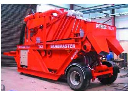
Il Finlay Sandmaster è disponibile in modelli su slitta o completamente mobili e può essere montato in un impianto di lavaggio esistente per massimizzare il recupero di sabbia e/o migliorare il drenaggio della stessa.
