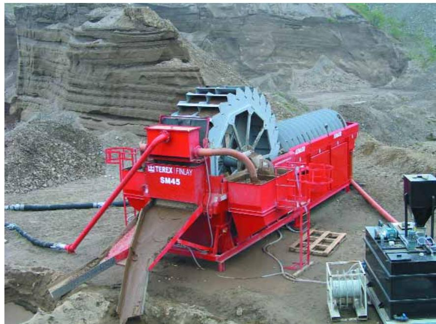
L'emploi d'une SILTMMASTER de Finlay, élimine la nécessité d'importants bassins de lavage, la consommation d'eau fraîche est réduite et le risque de pollution de l'environnement par la boue est évité. La Siltmaster existe en deux dimensions et peut faire partie d'une nouvelle installation de lavage ou être intégrée dans une installation déjà existante.
